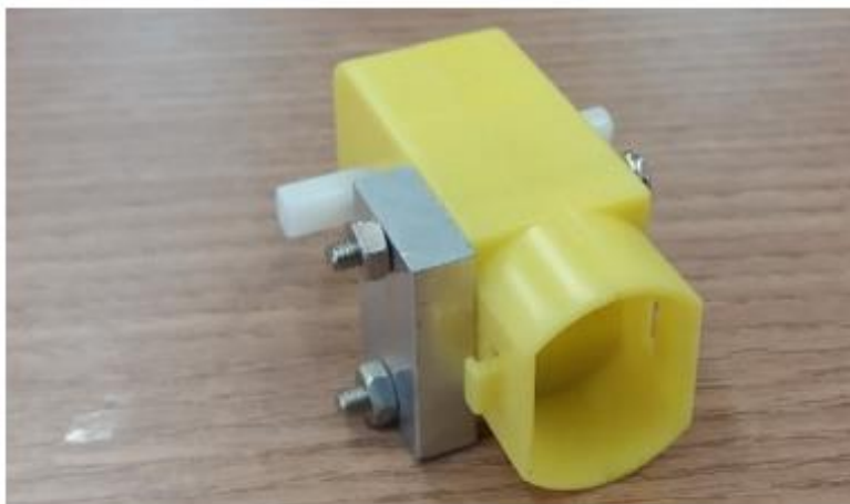
Figura 2 - Carcaça do motor com suporte para motor.
