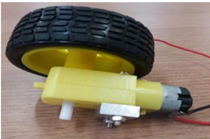
Figura 4 - Roda acoplada à carcaça do motor e suporte metálico.
